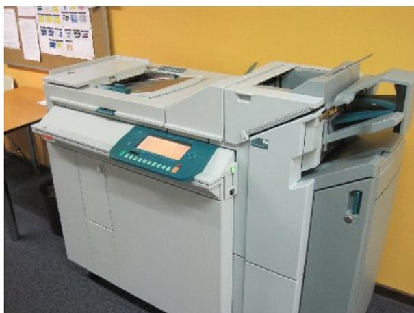
*Der Kopierer verbraucht selbst im Energiesparmodus noch stolze 264 W Strom. Daher wird er mittels Zeitschaltuhr nachts komplett vom Netz getrennt.*
